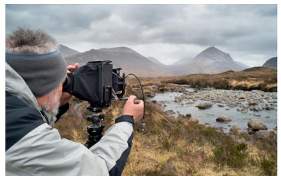
➤ Ein eigens konstruierter Mattscheibenbalgen ermöglicht auch bei Wind und grellem Sonnenlicht im Gelände das Fokussieren und die Bildkomposition auf der Mattscheibe. Er ist handlicher einsetzbar als das traditionelle schwarze Tuch
